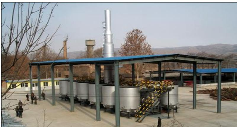
Batterie de 12 fours « CML/LRCB » : collecte/incinération des fumées et défournement à chaud
