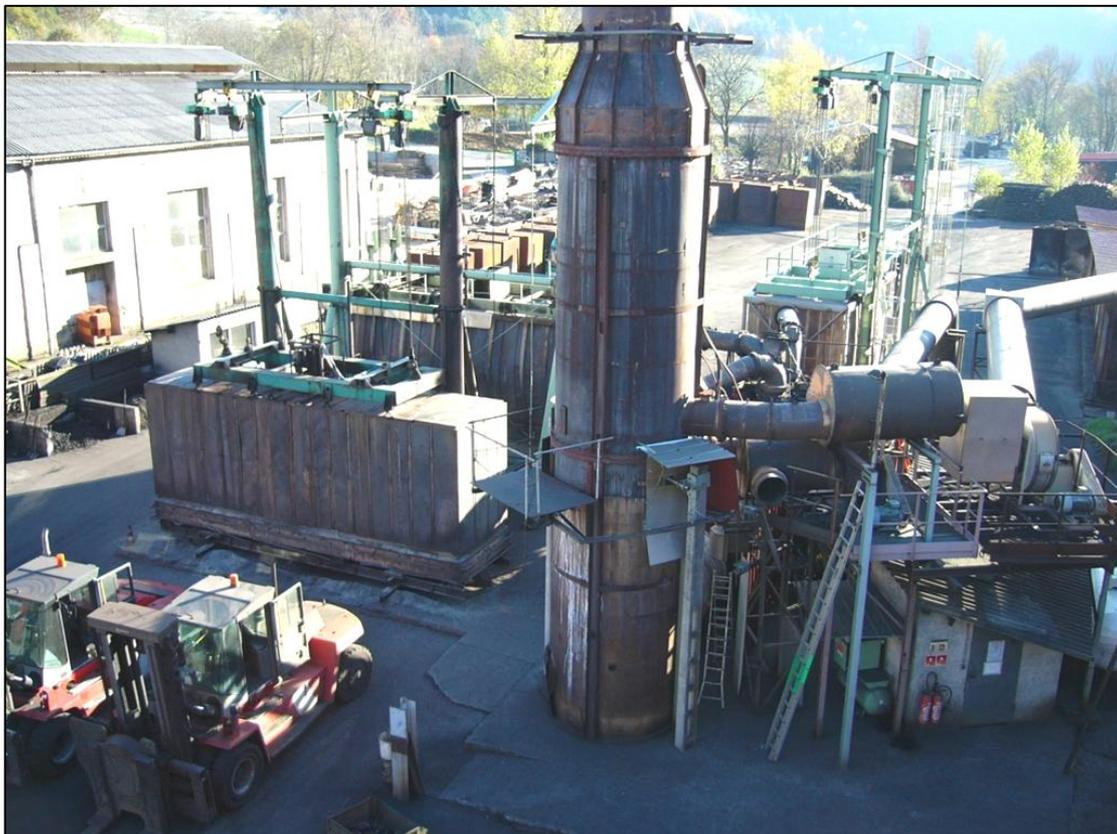
Exemple de 3 fours de carbonisation à brassage de gaz chauds, épuration des fumées, collecte des gaz chauds pour l'unité de préséchage des bois.
