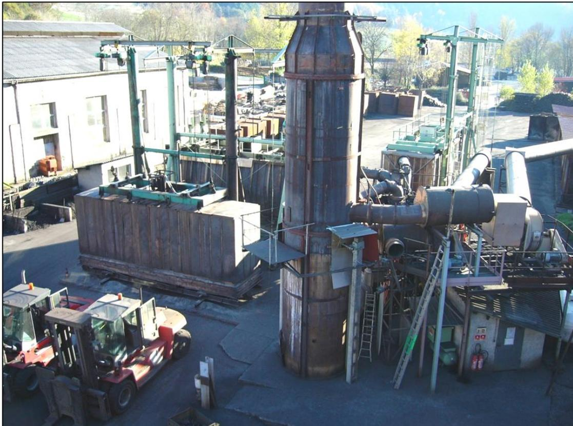
Figure 8 - Exemple de 3 fours de carbonisation à brassage de gaz chauds, épuration des fumées, collecte des gaz chauds. Capacité : environ 5.000 t/an, usine certifiée ISO 14001 (management environnemental).
