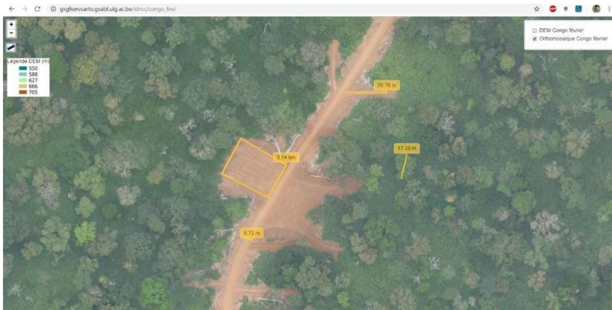
Figure 2.10 : Exemple de mesures de suivi de l'exploitation forestière à impact réduit d'une entreprise forestière certifiée FSC réalisées sur base d'une orthophoto drone.
