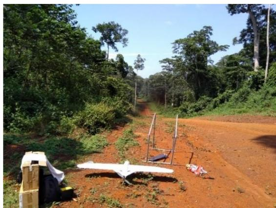
Figure 1.5 : L'aile fixe (type avion) Talon avec sa rampe de lancement sur le site de décollage étroit (route forestière).
