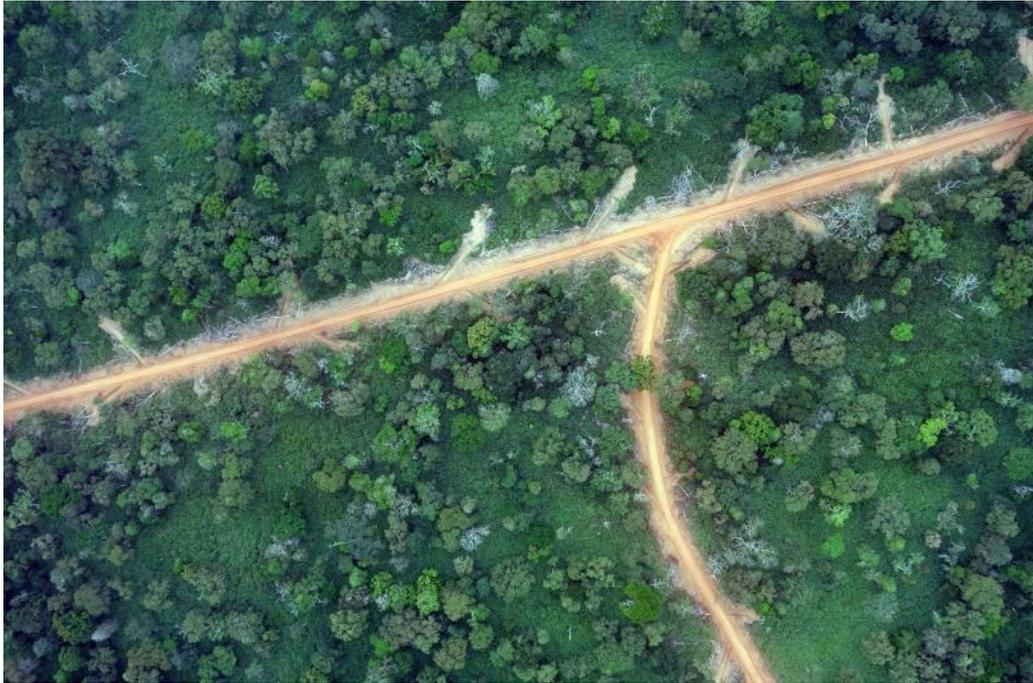
**Figure 1.24 : Les photos aériennes géo-localisées permettent de mesurer la largeur des routes, des pistes de débardage ainsi que les trouées. Les surfaces exploitées peuvent être localisées et mesurées avec précision.**
