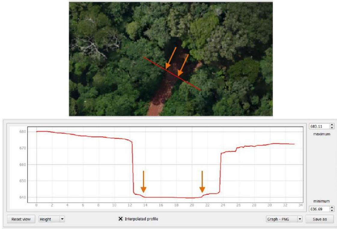
Figure 4.8 : Mesures de l'impact de la construction des routes sur la canopée, mesure des trouées.
