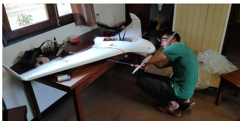
Figure 1.4 : Montage du drone VTOL sur le site d'IFO/IHC.
