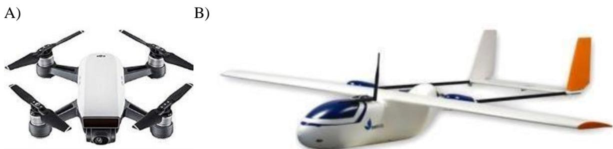
Figure 1.12 : A) drone à voilures tournantes (multicoptère), B) Tigerwing, un drone à voilure fixe.
