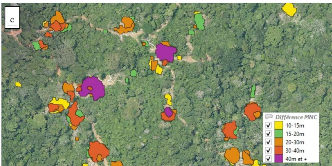
Figure 4.6 : Délimitation des zones perturbées dans la canopée : (a) orthoimage du vol 2, (b) différence de MNH (MNC=MNH dans légende) entre les 2 dates dans la strate arborée, (c) Perturbations opérées dans la strate arborée. Le sol nu encore apparent sur l'image c est le sol nu de la strat « marantacées ».
