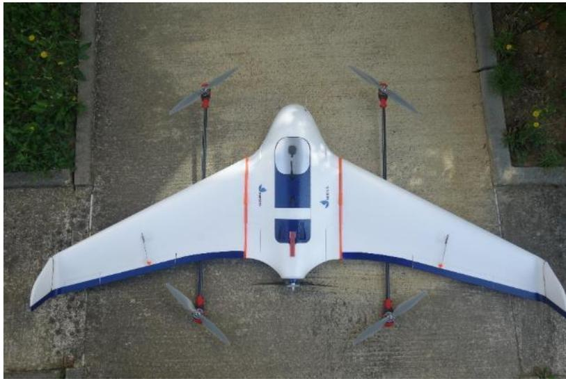
Figure 1.13 : Drone VTOL (Vertical Takeoff and Landing) développé par Sunbirds.
