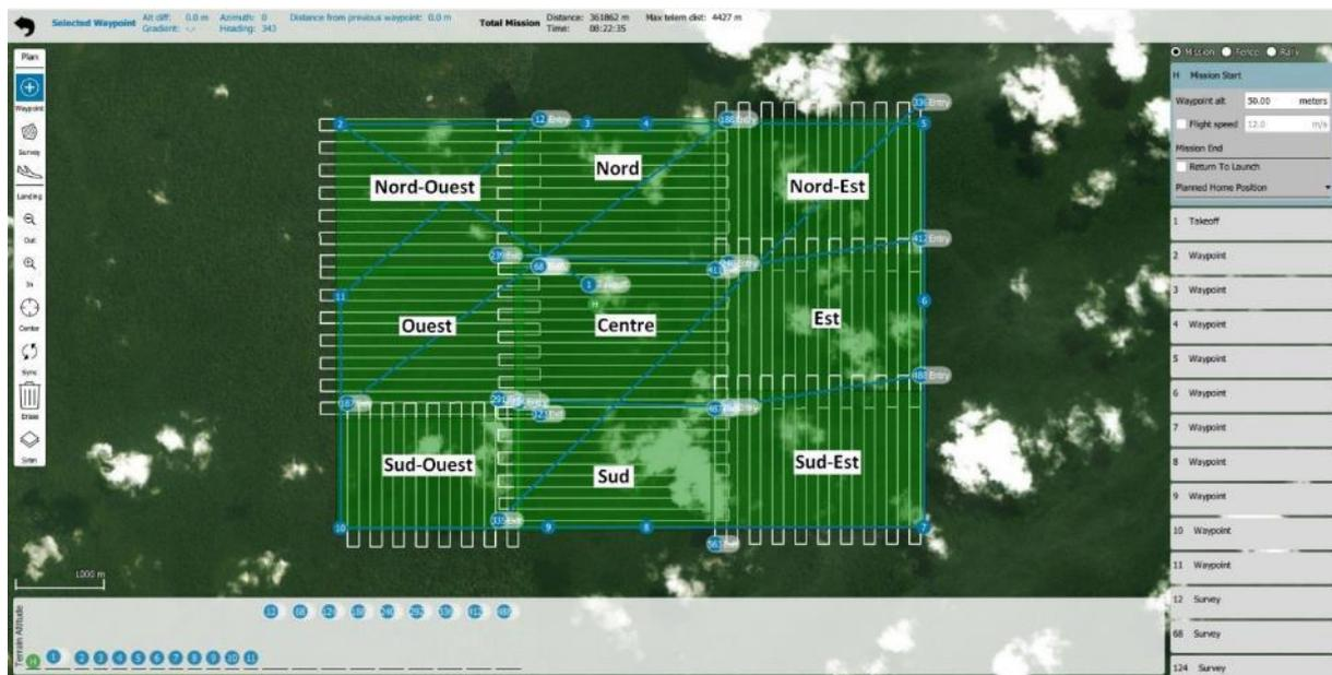
Figure 1.16 : Les 9 Plans de vol utilisés pour cartographier les 3.000 ha de l'assiette annuelle de coupe 2019 chez IFO/IHC. Réalisé avec Belvedere (Sunbirds).
