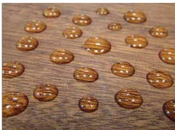
▲ Photo 15 : Tension de surface du bois © P. Martin, ATIBT
