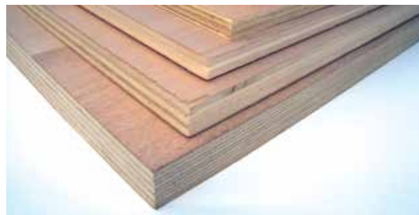
▲ Photo 30 : Différentes compositions de contreplaqué © M. Vernay
