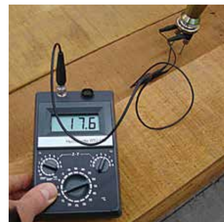
▲ Photo 16 : Humidimètre fonctionnant par résistivité. © P. Martin, ATIBT
