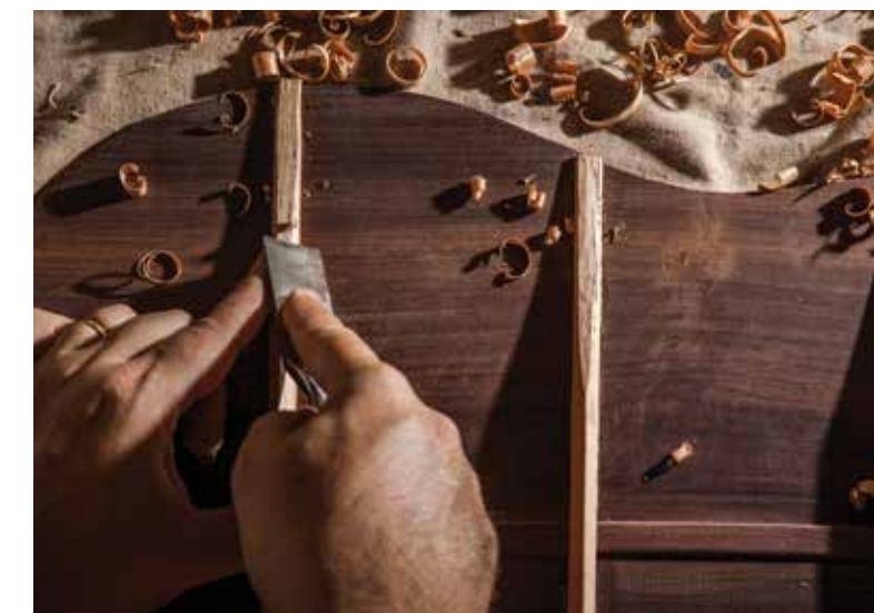
▲ Photo 85 : Table et barrages d'une guitare © Luciano Queiroz
